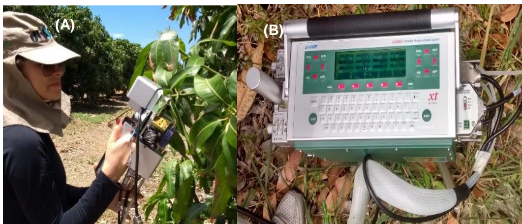
Figura 3- Análise da folha mediana por equipamento IRGA (A), Analisador de gás por radiação infravermelho IRGA (Mod. Li-COR®6400 XT) (B)
